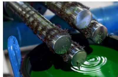
Магнитная вставка в механическом фильтре эффективно собирает остатки продуктов коррозии из сетевой воды.
